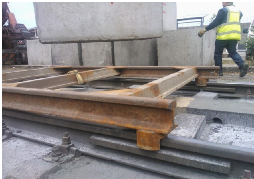
ნახ 8. ბეტონის ბლოკის მოთავსება წონის ტენზოგადამწოდებზე
