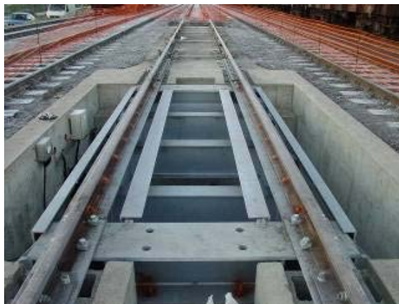
ნახ 3. ჩვეულებრივი ტენზოგადამწოდებიანი ასაწონი ხიდი
