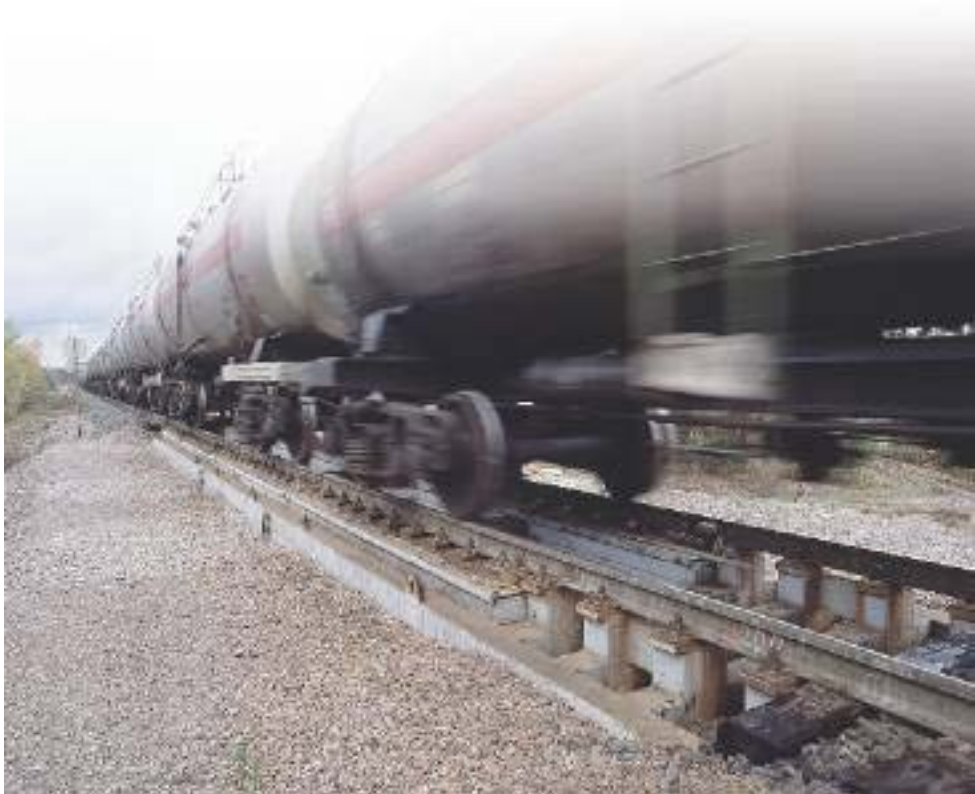
ნახ 10. სარკინიგზო სასწორი ზედაპირზე მონტაჟით
